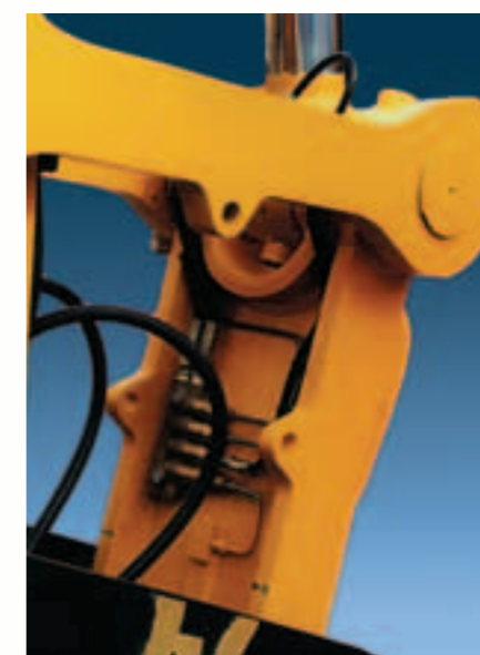
Rozváděcí blok namontovaný na ponorné rameno rypadla ukazuje použitý způsob ochrany.
