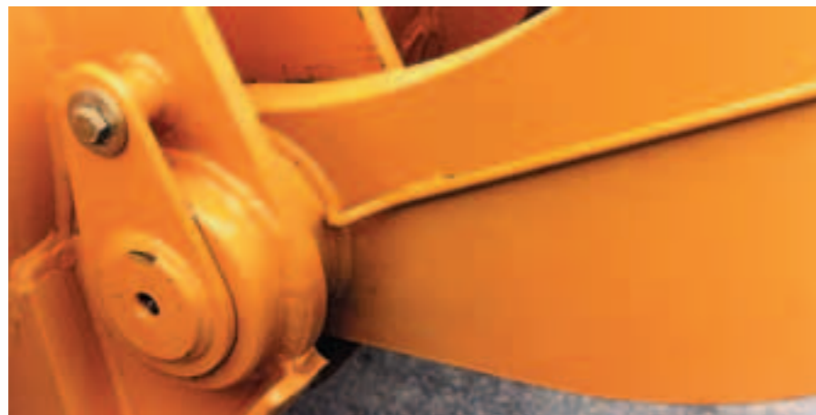
Mazací místo kuličku s nádobkou připojeného přes vysoce pevnou ocelovou trubku navařenou ke kostře.
